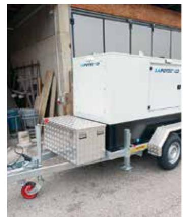
Mobiles Notstromaggregat für die Sicherung der Wasserversorgung in Althofen
