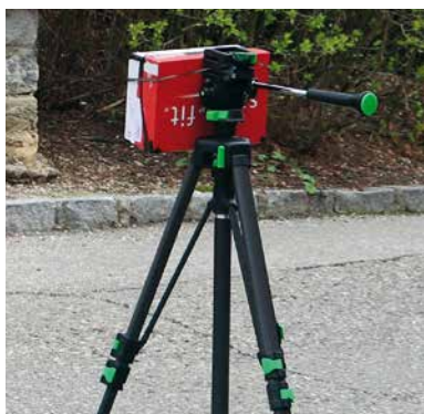
Lochkamera (Pappschachtel) am Stativ bereit für Aufnahme
