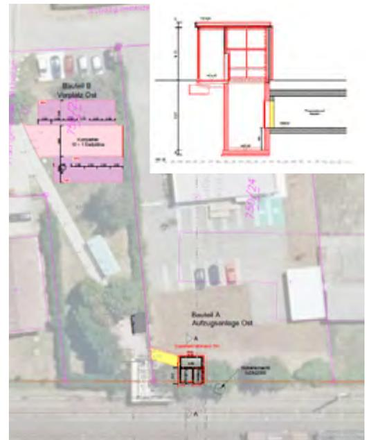
Abbildung 3: Schematische Darstellung des Projektes: 3. Lift und ostseitige Zugänglichkeit zum Bahnhof Treibach-Althofen.
