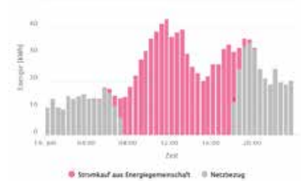
Abbildung 3: Verbrauchsprofil der EEG R 2 anhand eines typischen Sommertages
